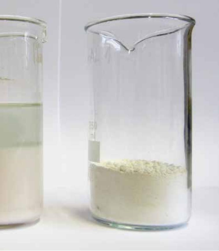
TetraPhos®-Produktschritte: Aufschluss der Klärschlammasche, Überstand gereinigte Phosphorsäure (RePacid), getrockneter Rückstand der Gipsfällung
